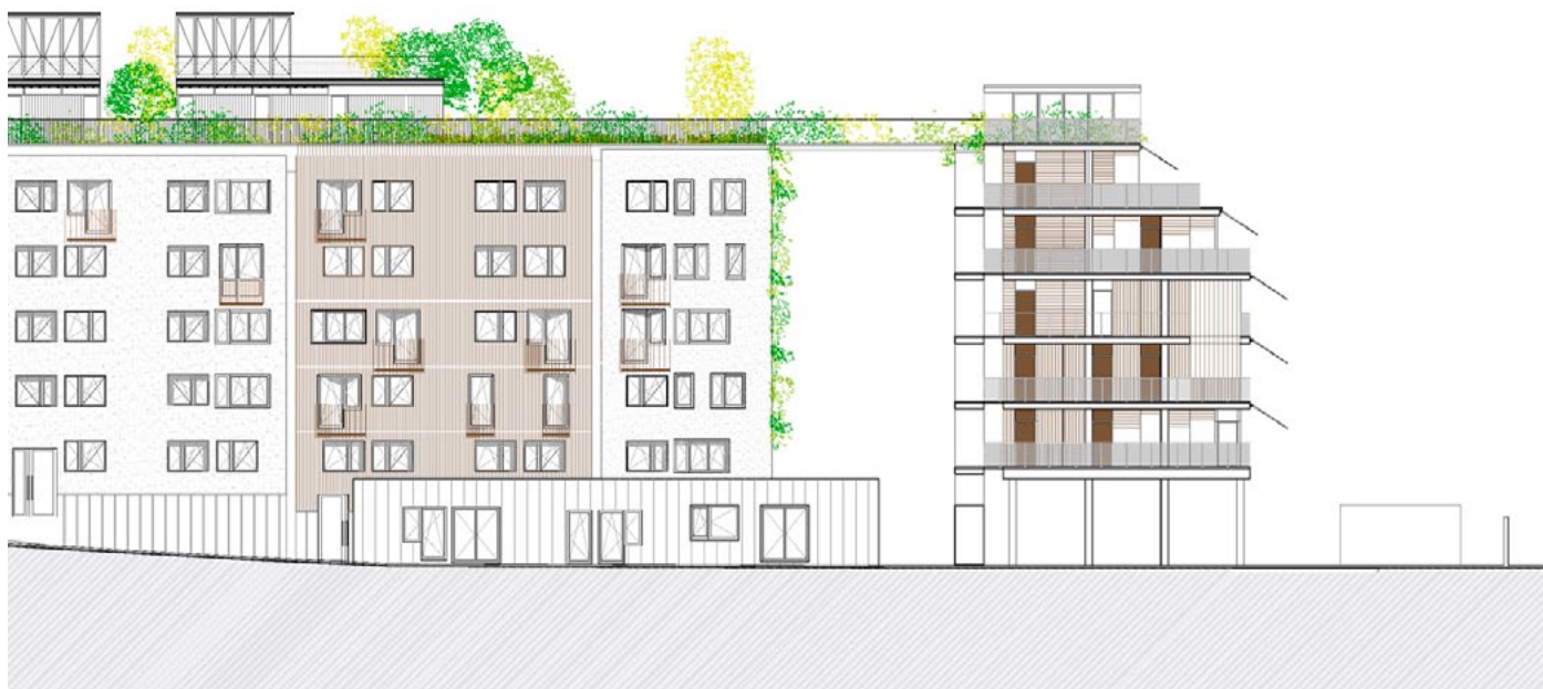
Façade nord-est côté rue Colbert (détail) avec extension et surélévation. © ADSC + AF
