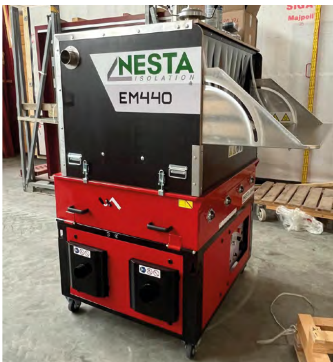
Machine à insufler nouvelle génération capable d'introduire dans les murs la paille hachée, la fibre de bois et la ouate de cellulose
